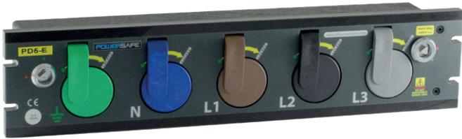
Die PowerSAFE Box ist eine Verbindungseinheit für den Anschluss mit Generatoren oder Netzspannung. Die Anschlüsse werden mit einpoligen Kabel gemacht. Die Reihenfolge von Verbindung und Trennung der einpoligen Kabel wird vorgegeben, um sicherzustellen, dass die Sicherheitstromkreise (N + PE) zuerst angeschlossen respektive zuletzt getrennt werden. Die codierten Verbindungen verhindern die Möglichkeit von falschen Kontaktierungen.
